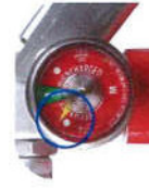
เครื่องดับเพลิง สภาพขัดข้อง (เข็มชี้ช่องแดง)
